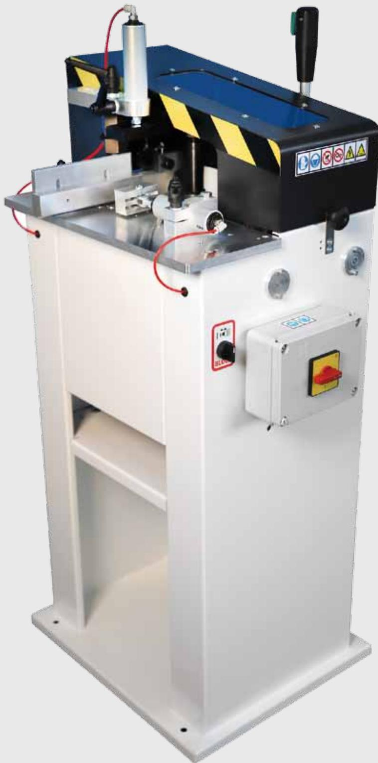
Fresatrice intestatrice orizzontale con avanzamento manuale del gruppo fresa, dotata di dispositivo per lavorazioni fuori squadra con gradazioni fisse  $-45^{\circ}, 90^{\circ}, +45^{\circ}$ . Fermo rotativo a 6 posizioni per la regolazione in profondita della lavorazione. Possibilità di effettuare operazioni di fresatura su gradi intermedi tramite fermo meccanico. Carter zona lavoro.
